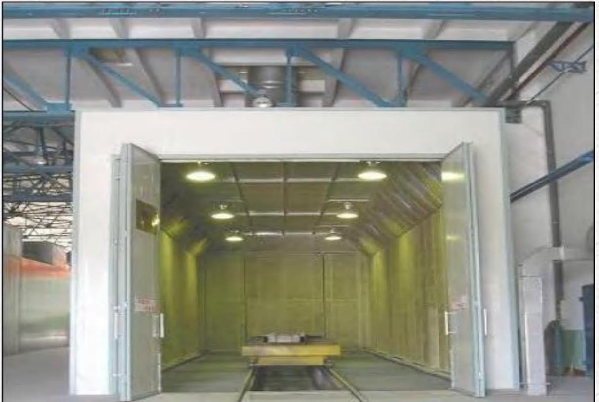
1: 规格为 7000\*10000\*4300. 立板用 75MM 硅岩板制作, 顶板用 EPS 夹芯板, 泡沫 12 克, 钢板厚度 0.4MM, 框架用镀锌方管制作。
