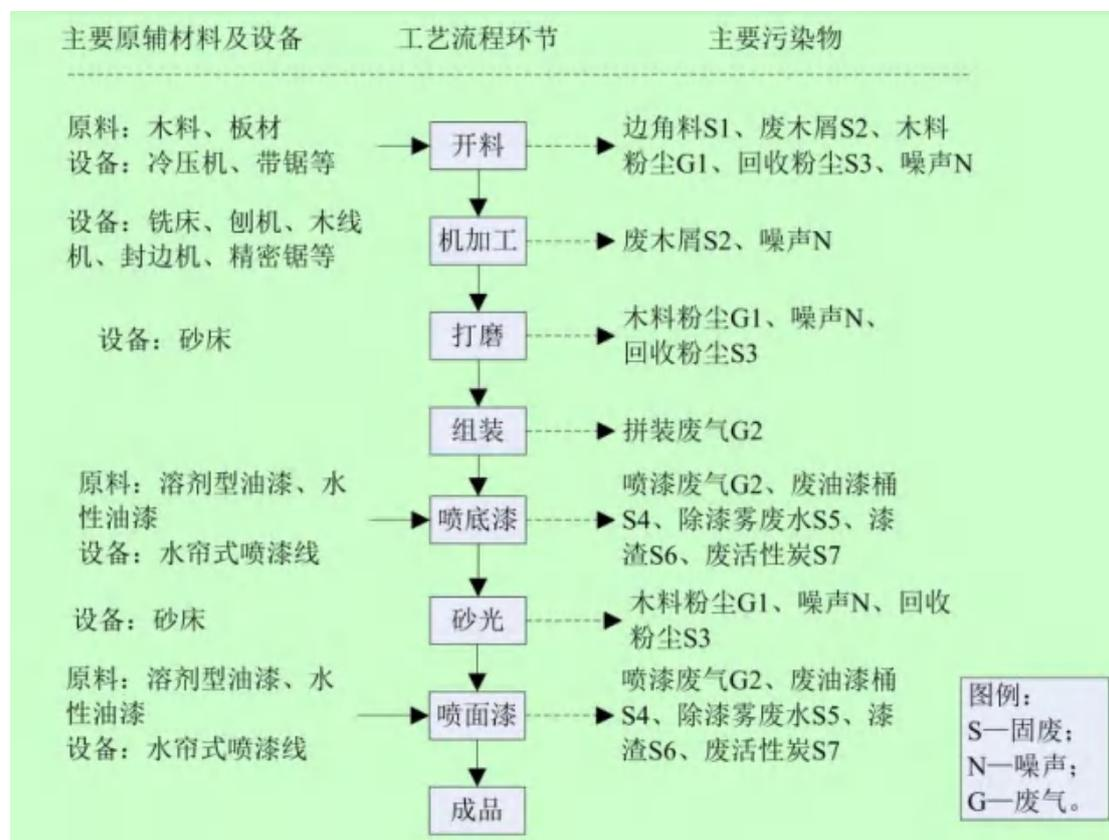
图 3-4 生产工艺流程及产污环节
