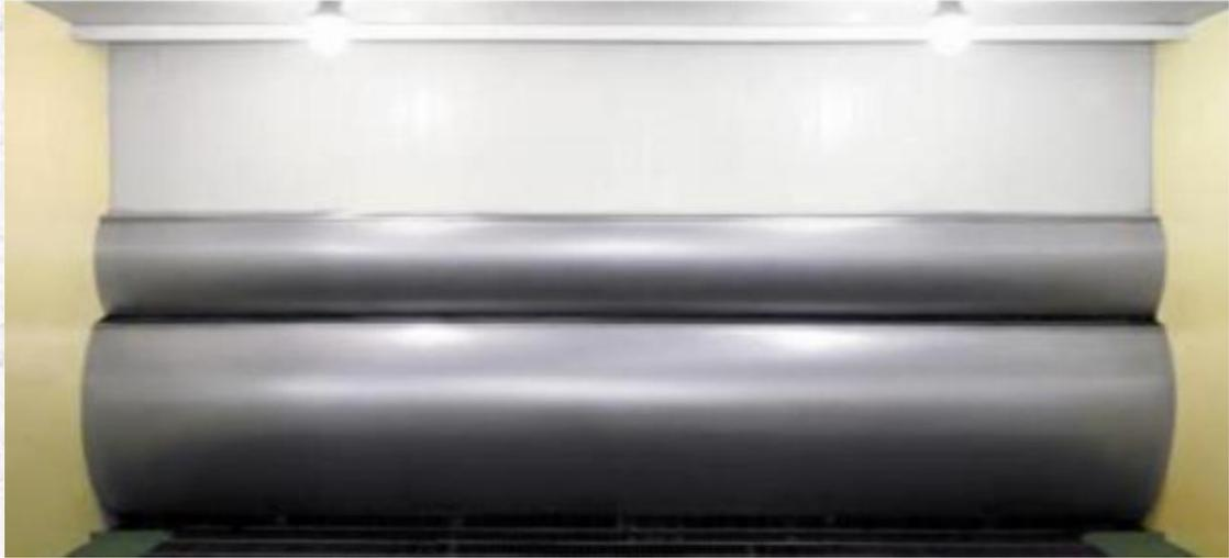
1. 混流式喷漆室的作用：是涂装系统中喷涂工件的场所，在喷涂工件时，超喷涂的油漆在经过喷漆台特殊设计部位时利用强大的水花将夹杂在空气中的油漆清洗过滤下来，达到清洁空气的良好效果。
