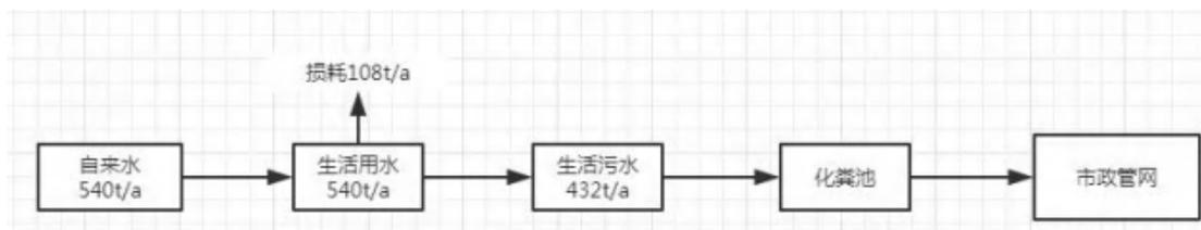
图 3-3 项目水平衡图
