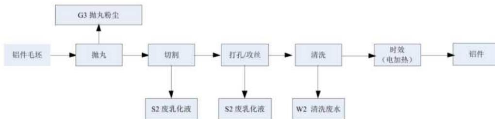
图 3-5 铝件生产工艺流程及产污节点图
