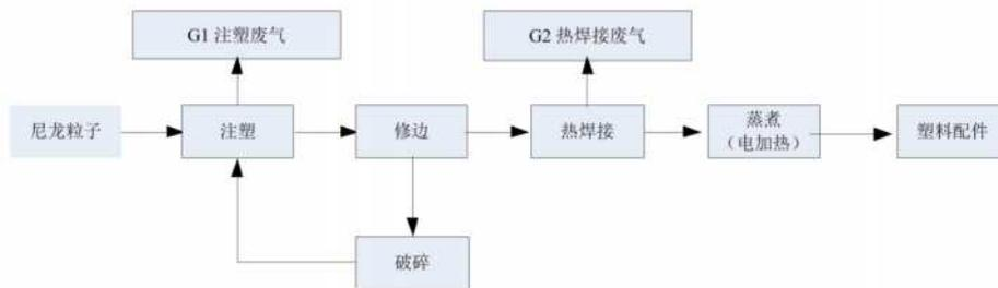
图 3-4 塑料部件生产工艺流程及产污节点图
