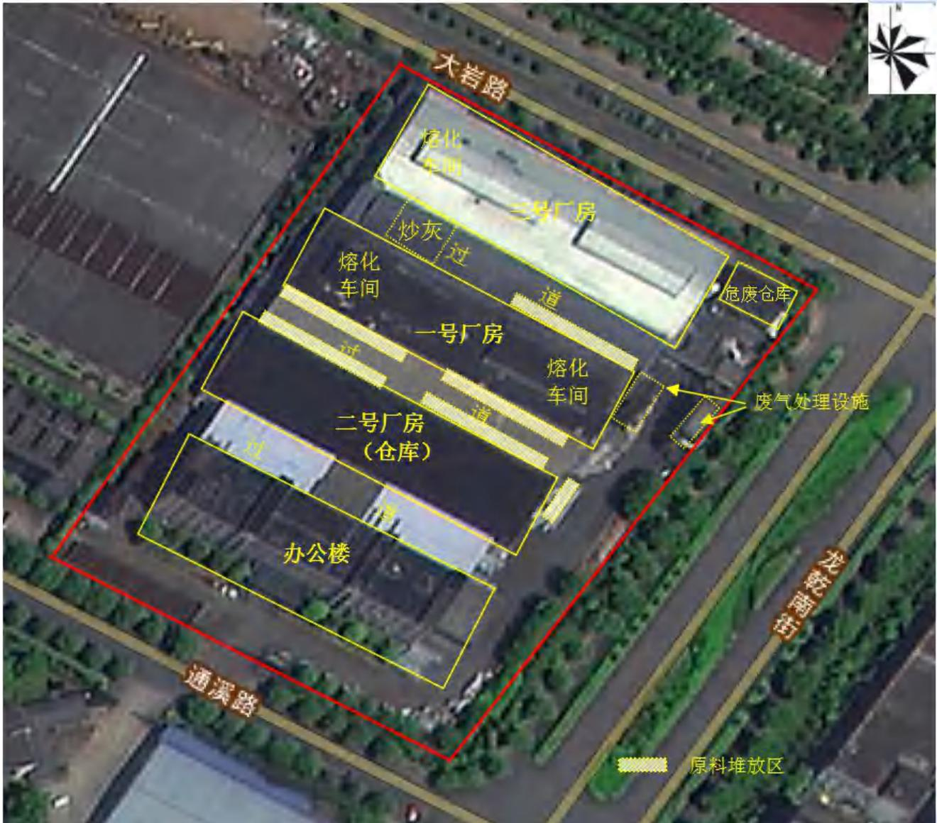
图 4-12 熔化车间、危废仓库、废气处理设施等位置分布图
