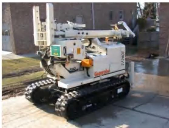
图 9-1 Geoprobe 型土壤一体钻机
