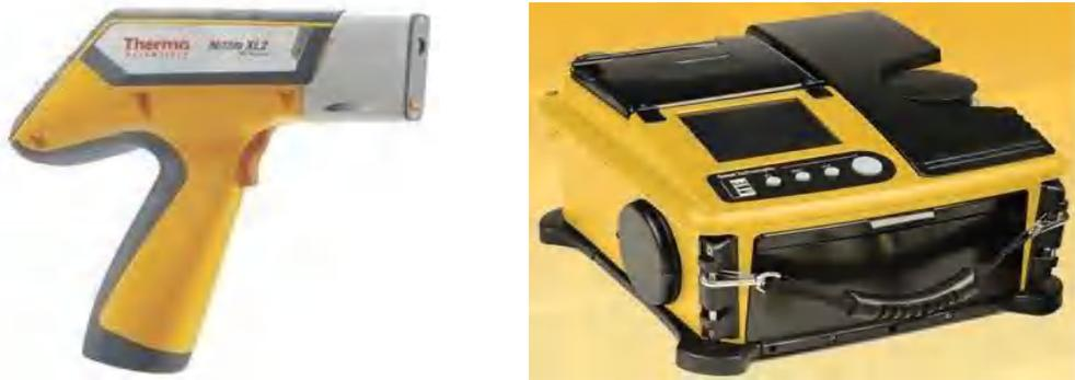
图 11-2 便携式重金属 XRF 分析仪（左）与便携式 GC-MS（右）
