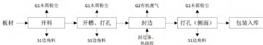
图 3-4 生产工艺流程及产污环节
