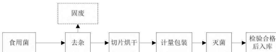
图 3-6 干燥食用菌加工工艺流程图
