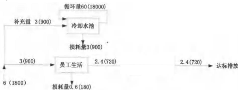
图 3-3 项目水平衡图 单位：t/d (t/a)
