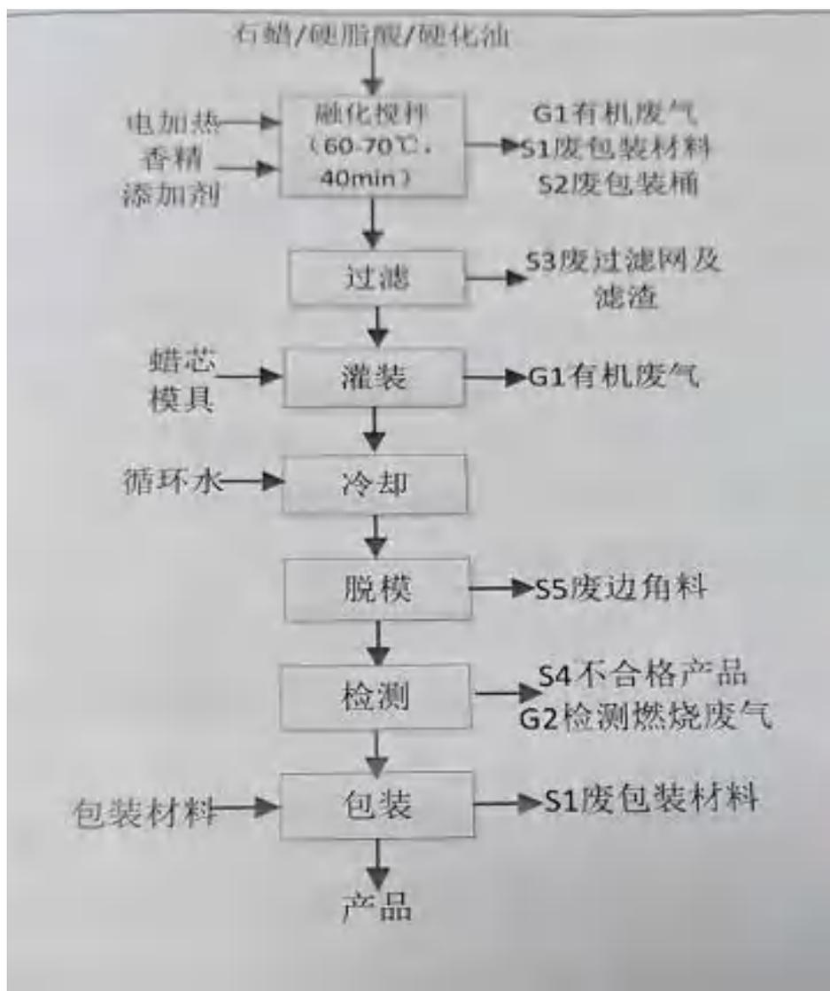
图 3-5 柱蜡生产工艺流程及产污环节
