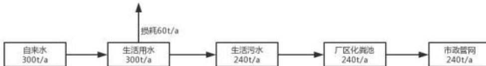
图 3-3 项目水平衡图
