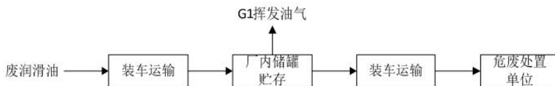
图 4-7 废润滑油收集贮存流程图
