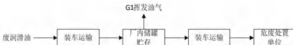
图 2-6 废润滑油收集贮存流程图
