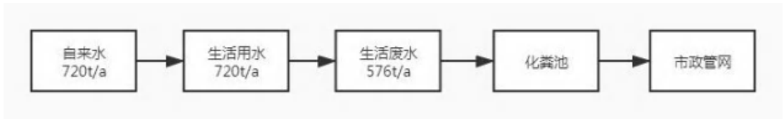
图 3-3 项目水平衡图
