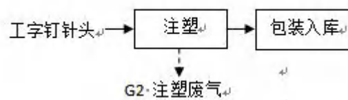
图 3 工字钉生产工艺及产污流程图
