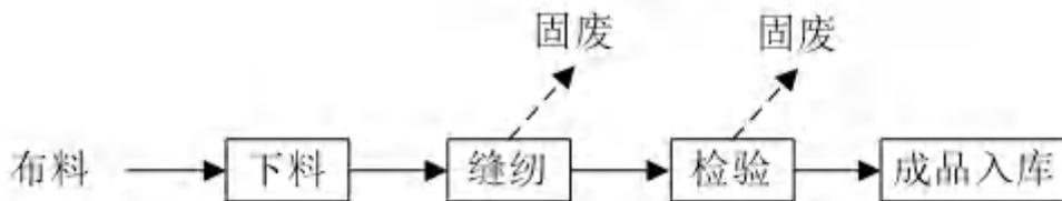
图 3-10 生产工艺流程图
