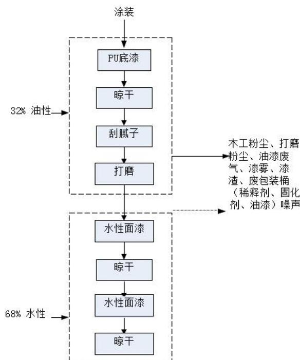
图 3-5 项目涂装工艺及产污流程图
