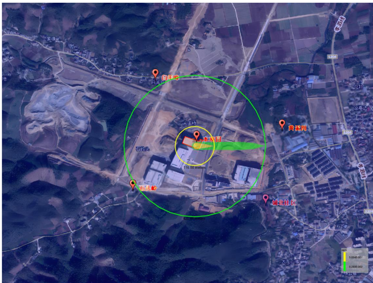
图7-4 二苯基亚甲基二异氰酸酯发生泄漏影响范围预测图
