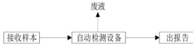
图 4.5-3 生化类实验工艺流程及产污环节
