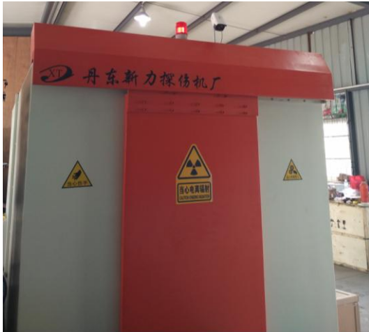
图 6-3 工件门电离辐射标志和警示灯
